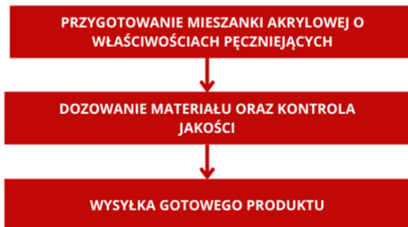
Rysunek 5.2: Uproszczony proces produkcji mas ogniochronnych
